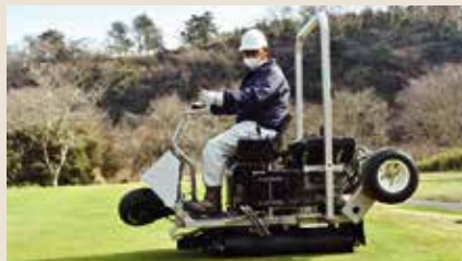
横に移動しグリーンをならす専用車。他にもゴルフ場の整備に合わせた様々な車両があります。
